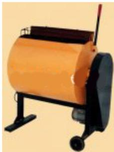
Смеситель циклический принудительного действия, предназначен для перемешивания жёстких и тяжёлых смесей. Используется для смесей плотностью выше 2,2 - 2,4 т/м<sup>3</sup>, водосодержанием ниже 6-8%, с повышенными абразивными свойствами компонентов - смеси для прессования тротуарной плитки, для приготовления огнеупорного бетона и так далее.
