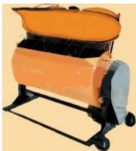
Смесители циклические передвижные принудительного действия, частота вращения вала 65 об/мин, предназначены для приготовления лёгких строительных растворов плотностью до 1,6 т/м<sup>3</sup>, водосодержанием около 10%.
