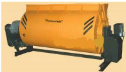
Смесители предназначены для приготовления сухих мелкофракционных смесей (насыпная плотность смеси не более 1200кг/м<sup>3</sup>) в производстве строительных материалов. Частота вращения перемешивающего вала 30 об/мин. Продолжительность опрокидывания барабана 14 с.
