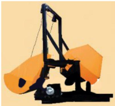
Профессиональные бетоносмесители гравитационного типа оснащённые скиповым подъёмником предназначены для приготовления подвижных бетонных смесей на плотных и пористых заполнителях с крупностью зёрен до 75мм.
